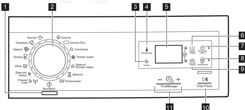
**1** Кнопка «Вкл/Выкл» ① (ВКЛ/ВЫКЛ)
